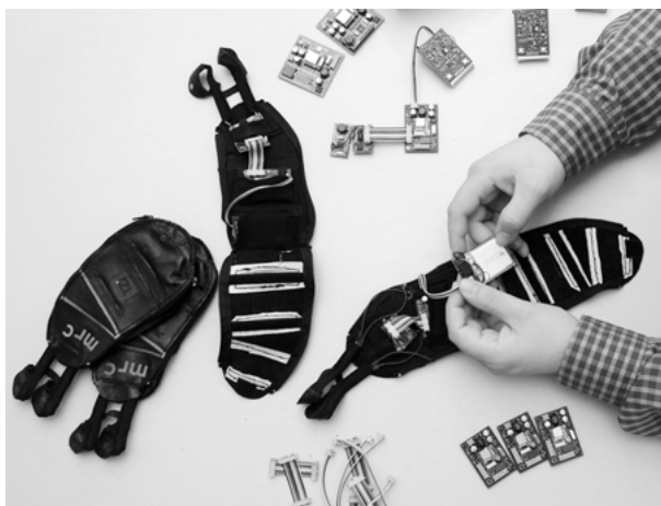
Abb. 7: Komponenten des optimierten Winspect-Eingabehandschuhs, 3. Generation (Bild: MRC)
