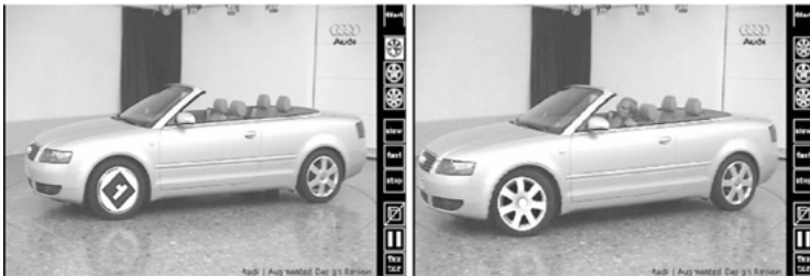
Abb. 5: Virtuelle Felgenvarianten am realen Fahrzeug (© Audi). Links: ohne Einblendung; rechts: mit Einblendung.
