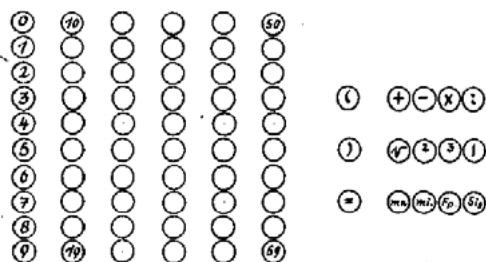
Abb. 7: Tastatur des Planfertigungsgerätes (Konrad Zuse Archiv von Horst Zuse in Berlin)
