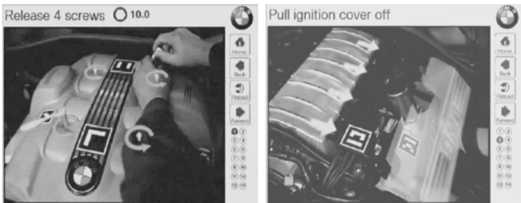
Abb. 4: Beispiele einer Augmented-Reality basierten Reparaturanleitung (© BMW AG).
