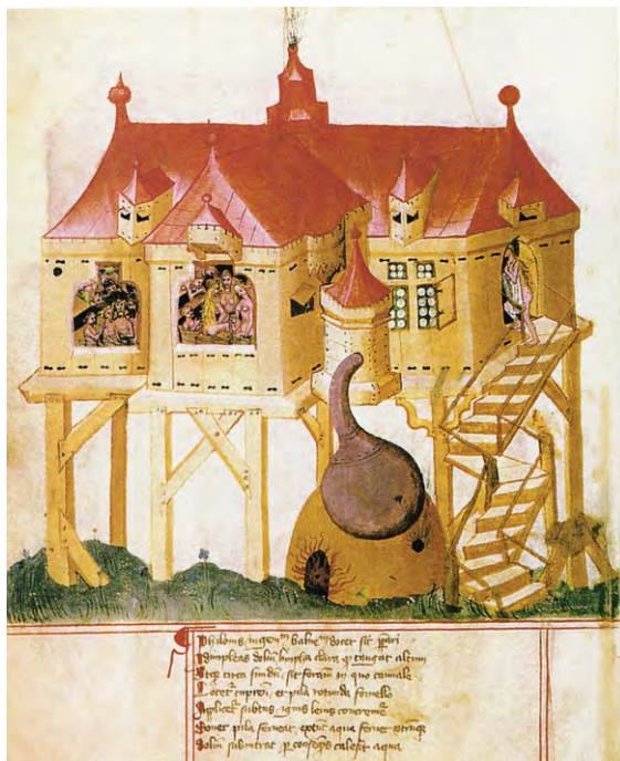
Abb. 4: Badhaus (gemauerter Kuppelofen mit kupferner Sudblase, Frauen- und Männerstube, auf der Treppe eine kaum bekleidete Badbesucherin); kolorierte Zeichnung aus dem »Bellifortis« des Konrad Kyeser, 1405.
