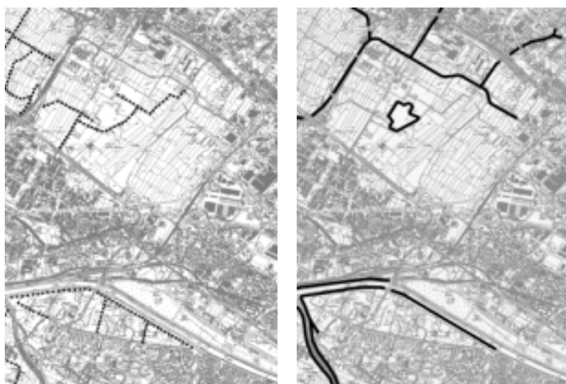
Figura 39 – Simulazioni degli scenari teorici (3) “ Equipaggiamento paesistico della rete viaria rurale ”, a sinistra e (4) “ Equipaggiamento paesistico dei corsi e corpi d'acqua e delle aree di intervento per la difesa idrogeologica ”, a destra (cartografia ridotta da originale 1:10000 – CTR Regione Toscana).
