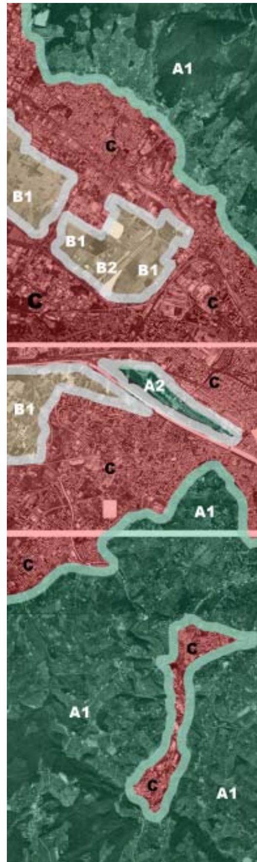
Figura 31 - Diagnosi di frammentazione paesistica - condizioni di stato - 1° livello diagnostico: unità di paesaggio (rappresentazione su fotografia aerea zenitale - Regione Toscana, scala originale 1:30000).
