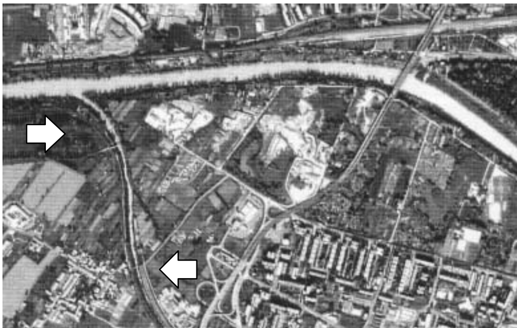
Il corso del fiume Greve alla confluenza in Arno. È evidente l'analogia rispetto ad un canale di bonifica, assunta dal corso d'acqua a seguito delle opere di regimazione idraulica. Rappresentazione fotografica zenitale 1:15000 (da formato digitale 1:30000 – Regione Toscana). Rappresentazione planimetrica 1:5000 (da CTR 1:10000 – Regione Toscana).
