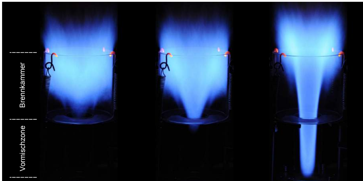
Abbildung 1.1: Drei Momentaufnahmen einer drallstabilisierten Vormischflamme beim Flammenrückschlag durch verbrennungsinduziertes Wirbelaufplatzen.
