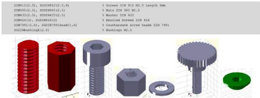
Abb. 5: Hinterlegte Normteile (Beispiele) für Konstruktionsaufgaben, aus [6]
