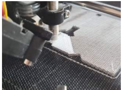
(b) Erste Schicht, die durch das Stoffnetz gedruckt wird
