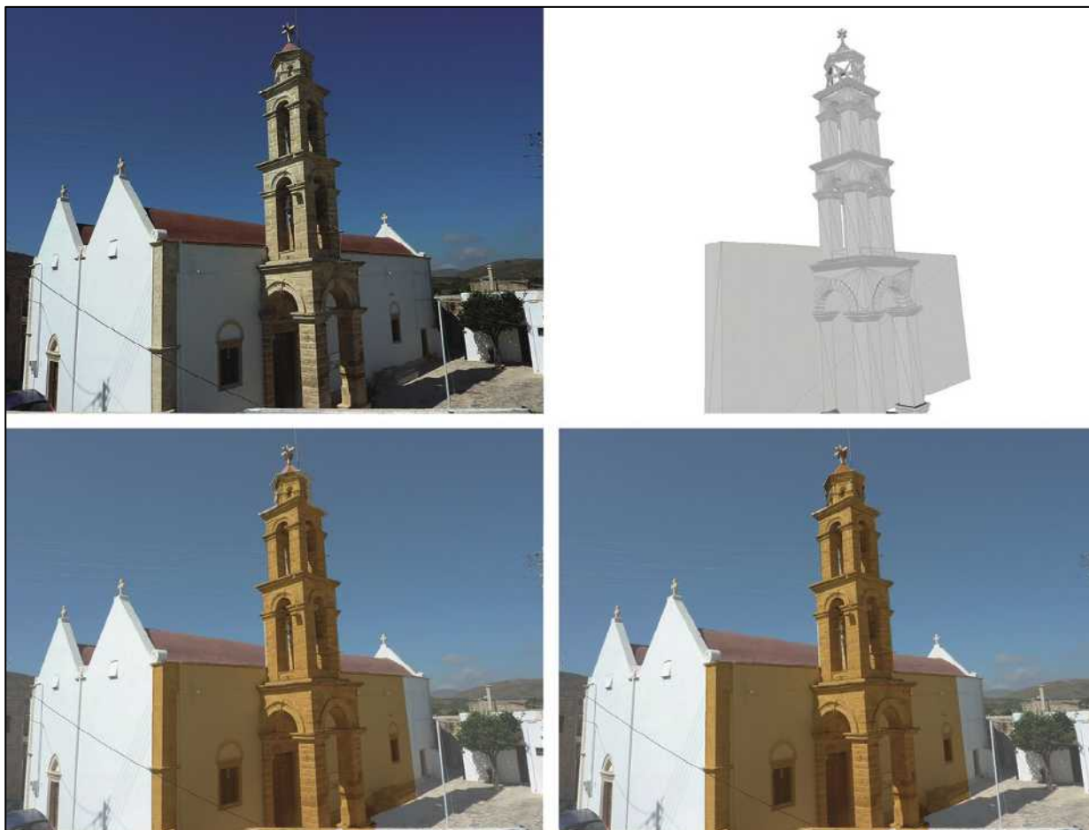
Figura 2. Fotografia del campanile da archivi online prima del fulmine (in alto a sinistra); modello 3D matematico semplificato del campanile da un punto prospettico simile (in alto a destra); prima convalida con allineamento immagine-geometria (in basso a sinistra); aggiustamento del modello per adattarlo meglio alle informazioni della fotografia (in basso a destra).
