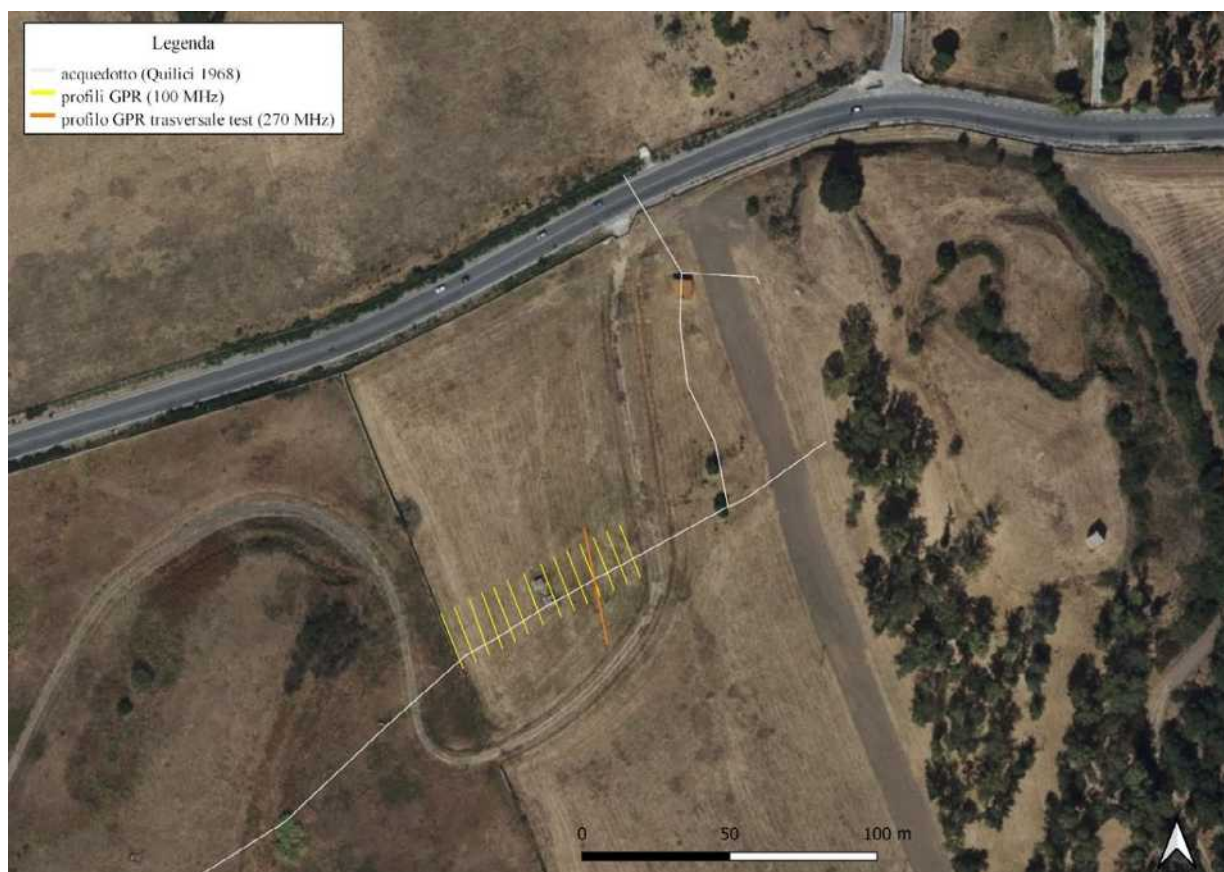
Figura 4. Salone. Settore B. Profili georadar effettuati in rapporto all'acquedotto con antenna 100 MHz (in giallo) con antenna da 270 MHz (in arancione) (elab. QGIS dell'autrice su base Bing Satellite; map data: Microsoft® Bing™).
