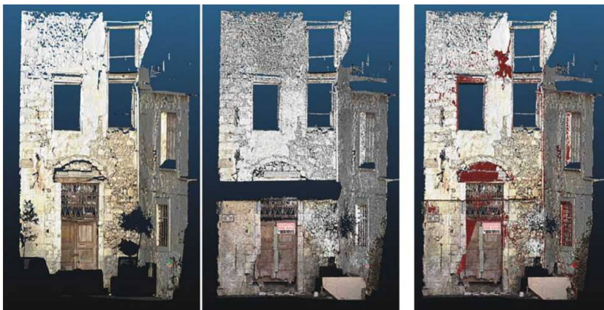
Figura 5 – Fabbrica di sapone, Rethymno. Scansione laser terrestre di ottobre 2016 e febbraio 2018 (a sinistra e al centro) e confronto tra le due con i punti statisticamente significativi in rosso (a destra). Le aree scure in entrambe le nuvole di punti sono dovute a ostacoli inamovibili (rimossi digitalmente) nella parte inferiore dell'edificio.
