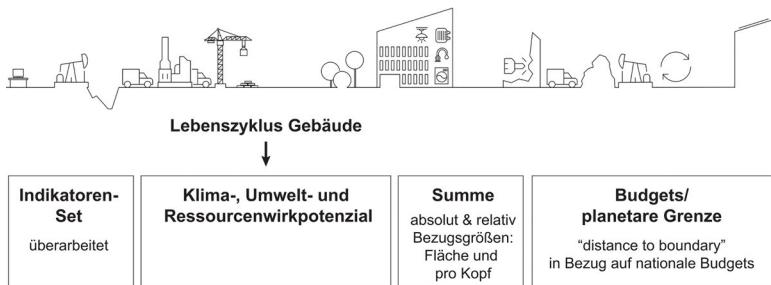
Abbildung 42: Skizze zur Verdeutlichung der Zusammenhänge zwischen Umwelt- und Klimawirkpotenzialen (anhand eines ausgewählten Indikatoren-Sets), deren Anfall und Größenordnung innerhalb des Lebenszyklus eines Gebäudes (Module A–D sowie in Summe) und deren Zuordnung zu den planetaren Grenzen (Bezug zu nationalen Budgets) (BBSR, eigene Darstellung)
