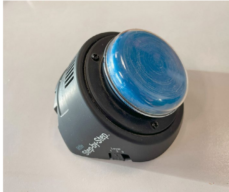
Abb. 2.6.2: Step-by-Step-Kommunikationshilfe: Beim Drücken der Taste wird ein gespeichertes Audio wiedergegeben.
