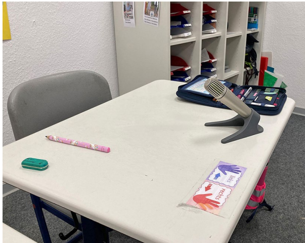
Abb. 2.4.3: Schülerinnen- beziehungsweise Schüler-Mikrofon einer Übertragungsanlage
