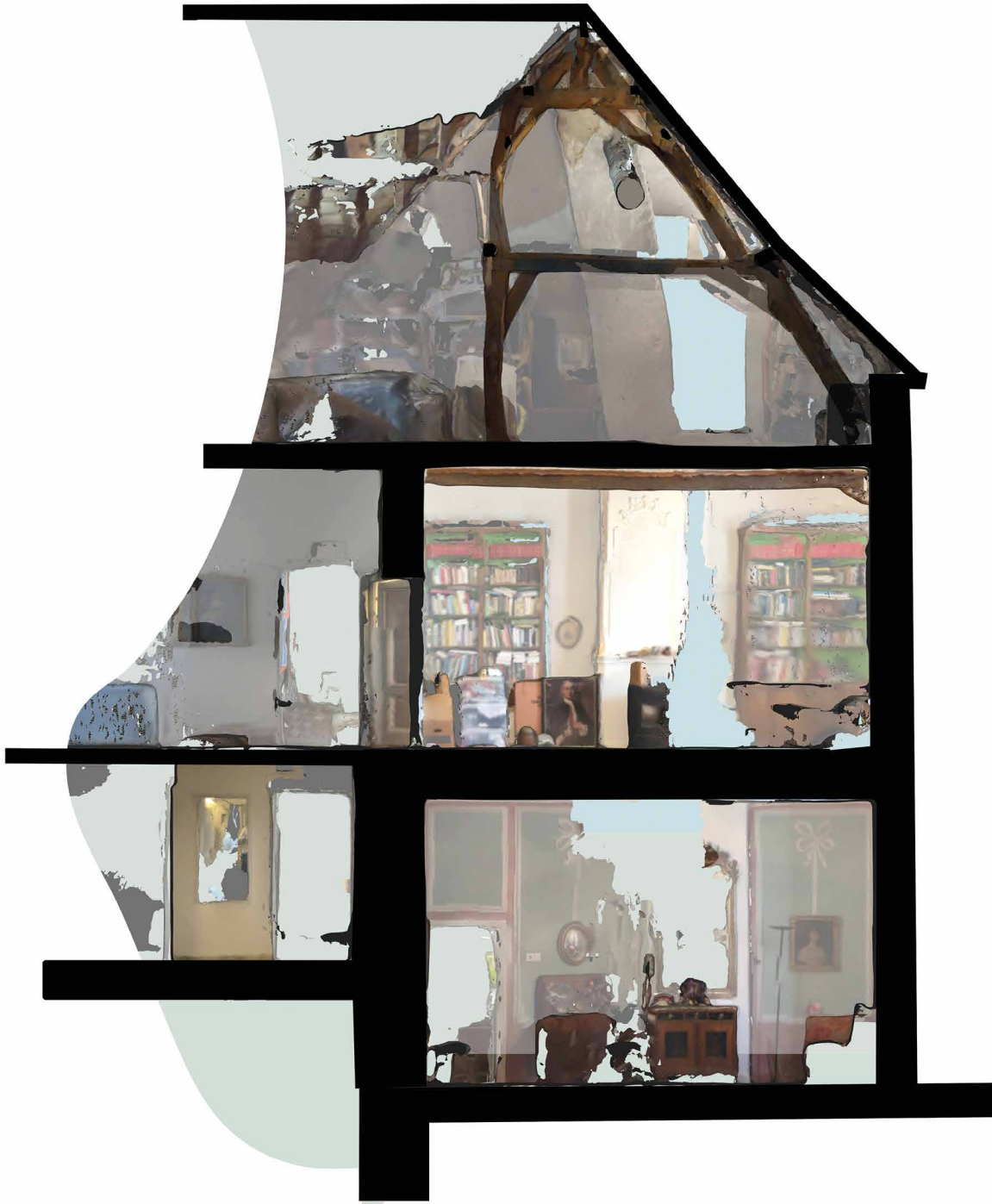
Afb. 13. Weergave van LIDAR-scan-doorsnede over de aansluiting tussen bouwfases I (links) en IIa/b (rechts). De terugwijkende kapconstructie steunt onlogisch af op een vloerbalk.
