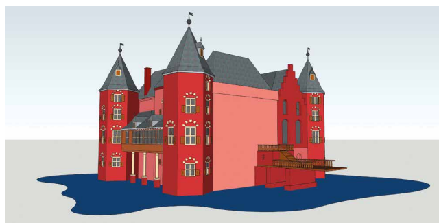
Afb. 52. Impressie van de opzet van het kasteel op het moment dat de galerij langs de zuidgevel van de nog ongewijzigde middeleeuwse bouwdelen was gelegd. Aangezien de galerij over de oude toegang werd gebouwd was de toegang waarschijnlijk al naar de oostgevel verplaatst. Tekening auteur.
