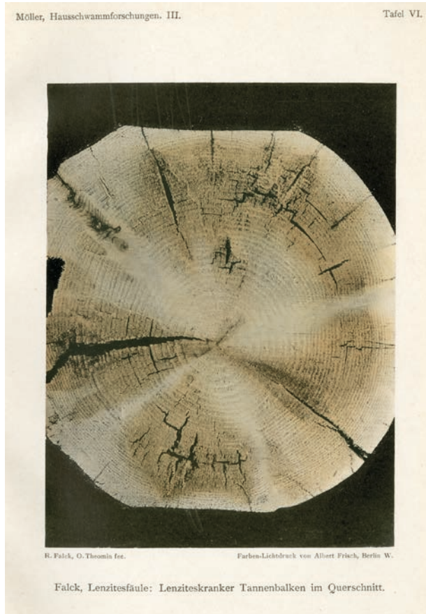
Abb. 72: „Lenziteskranker Tannenbalken im Querschnitt“. 1206
