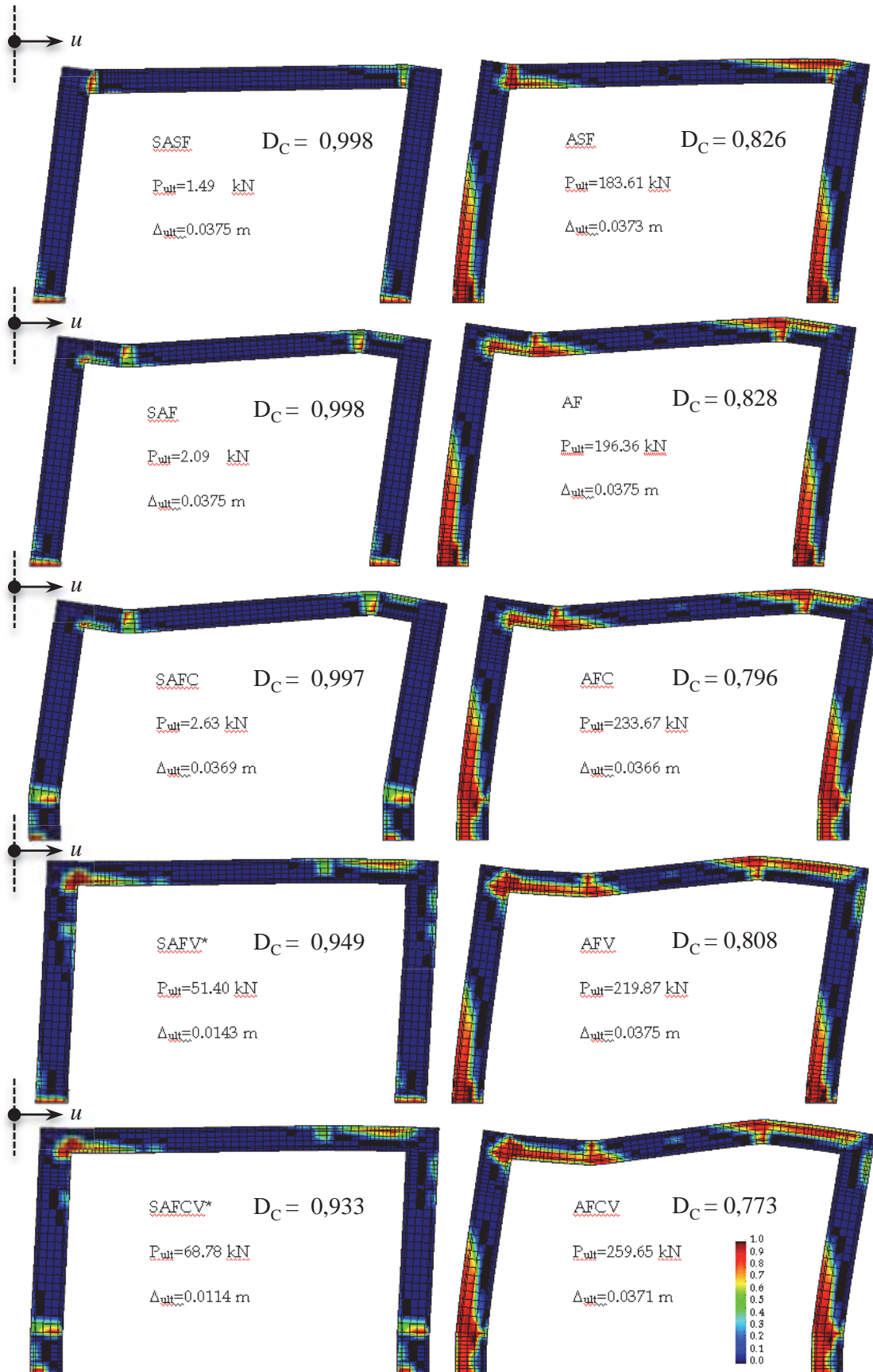
Figura 11.16: Daño estructural producido por un desplazamiento u en el extremo izquierdo.
