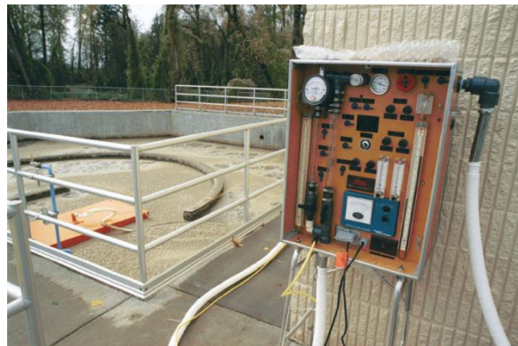
Figura 9.27 Mecanismo para la medición de las emisiones de gases (foto: M.K. Stenstrom)
