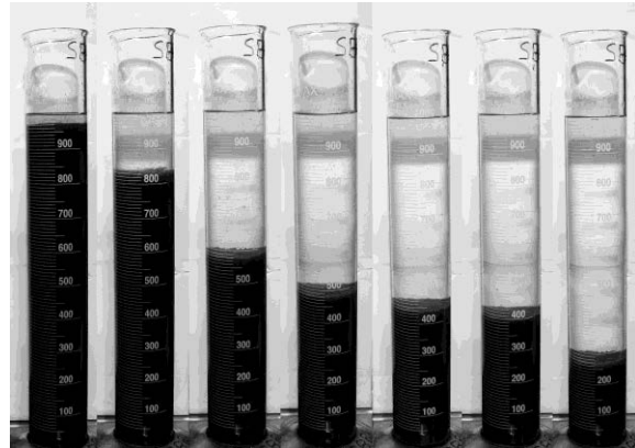
Figura 12.13 Altura de la interfase del lodo como una función del tiempo en una prueba VZS
