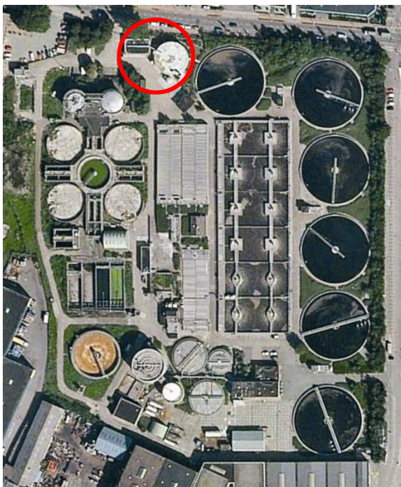
Figura 6.4 PTAR Beverwijk, el círculo rojo muestra el área usada para el proceso SHARON ® tratando 1,200 kgN por día
