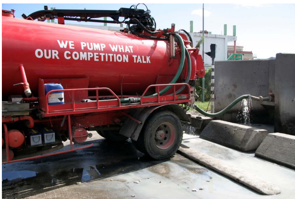
Figura 3.5 Camión cisterna descargando el contenido de fosas sépticas de hogares en un tanque de almacenamiento en la plata de tratamiento de Illidge Road en St. Maarten, N.A. (foto: D. Brdjanovic)
