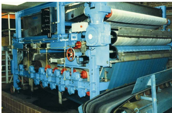
Figura 3.8 Filtro de Bandas para deshidratar lodos: la captación del agua de rechazo se da por debajo del equipo (Foto: D. Brdjanovic)
