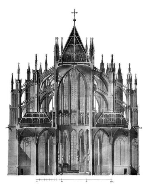
Fig. 4. Cross section of the choir at Cologne Cathedral in Sulpiz and Melchior Boisserée's *Ansichten, Risse und einzelne Theile des Doms von Köln* (Elevations, Sections, and Details of the Cathedral of Cologne).
