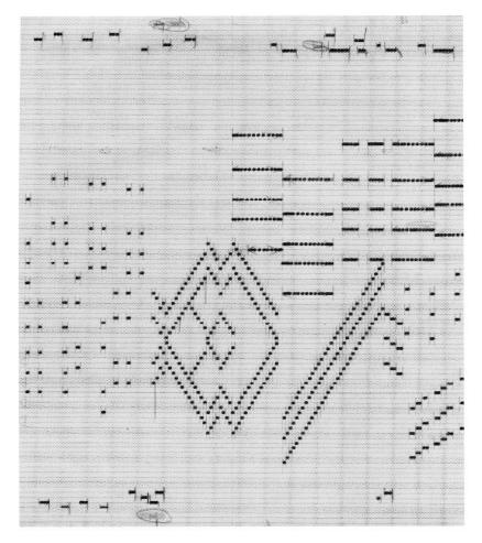
**FIGURE 1.** Excerpt of the piano roll for Hans Haass's "Intermezzo" (1927). The horizontal axis represents time, the vertical pitch. Source: Jürgen Hocker, *Faszination Player Piano: Das Selbstspielende Klavier von den Anfängen bis zur Gegenwart* (Bergkirchen: Edition Bochinsky, 2009), 234.
