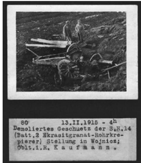
51 Durch Rohrkrepierer zerstörtes Geschütz
