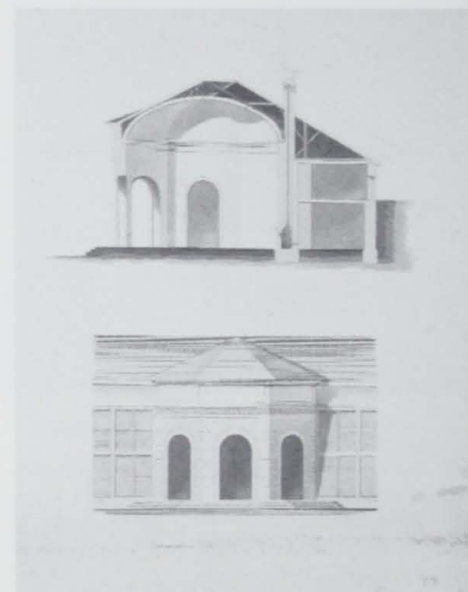
Abb. 78: Ansicht und Schnitt des veränderten Mittelpavillons
