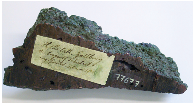
Abb. 32: Rohkupferschmelzkuchen (Grabungsfeld Salzberg, Hallstatt) mit geringmächtiger grüner Verwitterungsschicht (vorwiegend Malachit), ohne sulfidischer Reaktionsrinde, PA Inv.-Nr. 77.677; Fund von 1864.
