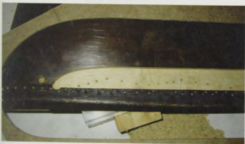
Abb. 2: Der in der Ebene der Stifte gerissene Anhängestock wurde vermutlich um etwa 1870 ausgestemmt und mit neuen Anhangstiften versehen. Dieser Bereich wurde ausgefräst und mit neuem Holz ausgesetzt.
