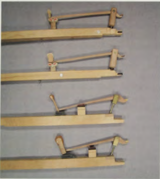
Abb. 2: Hammerköpfe der Tasten f^3 und F_1 , aus Hammerflügel Geschwister Stein, Augsburg 1794 (SAM 626) oben und Anton Walter, Wien ca. 1800 (SAM 539) unten. (Intonierleder von Walter original.)
