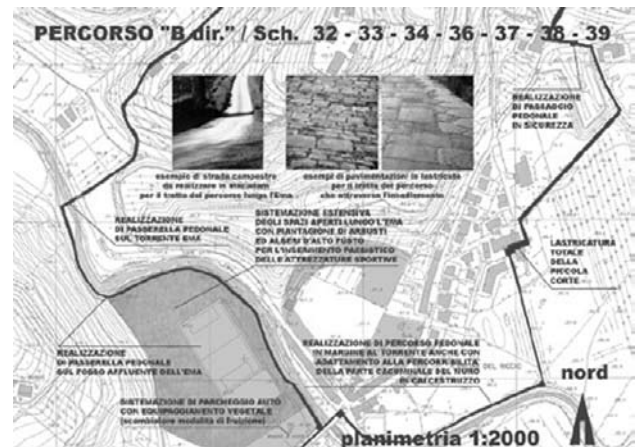
Figura 15. Esemplificazione di planimetria di approfondimento progettuale relativa alla sistemazione di un tratto di percorso pedonale extraurbano delle colline fiorentine in località Ponte all'Asse (originale in scala 1:2000).
