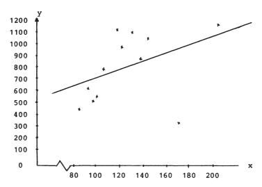
Die Regressionsgerade lautet: y = 364.4 + 3.43 x. Der Korrelationskoeffizient weist einen Wert von 0,41 auf; bei einem Konfidenzniveau von 1 -  $\alpha = 0.99$  ist er nicht signifikant.
