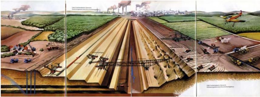
Abb. 3: Schematische Übersicht eines Braunkohletagebaus<sup>10</sup>
