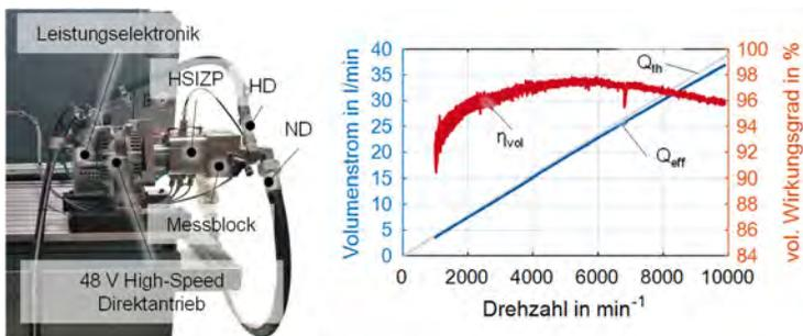
Abbildung 2.1: 48 V elektro-hydraulischer High-Speed Antrieb (links) und Volumenstrom und volumetrischer Wirkungsgrad über Antriebsdrehzahl (rechts).
