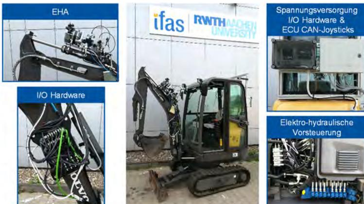
Abbildung 3.1: Versuchsmaschine VOLVO EC18.
