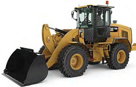
Abbildung 2.1: Ausgangssituation – 13 Tonnen Radlader.
