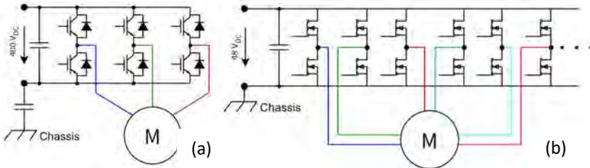
Abbildung 4.1: (a) 3-Phasen Hochvolt-Inverter, (b) 48-V-Multiphaseninverter.
