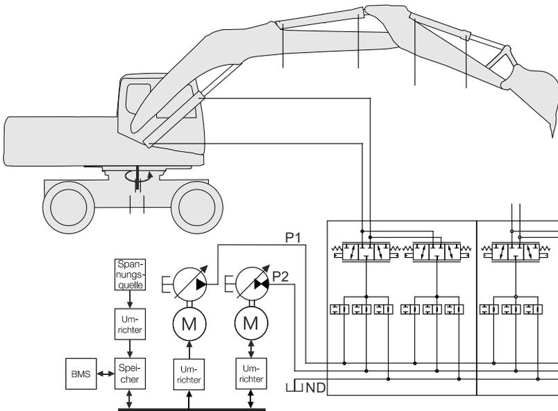
Abbildung 3.1: Aufbau Mehrdrucksystem.
