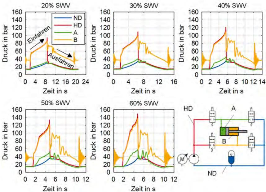
Abbildung 3.7: Druckverläufe über der Zeit für SWV zwischen 20% und 60%.
