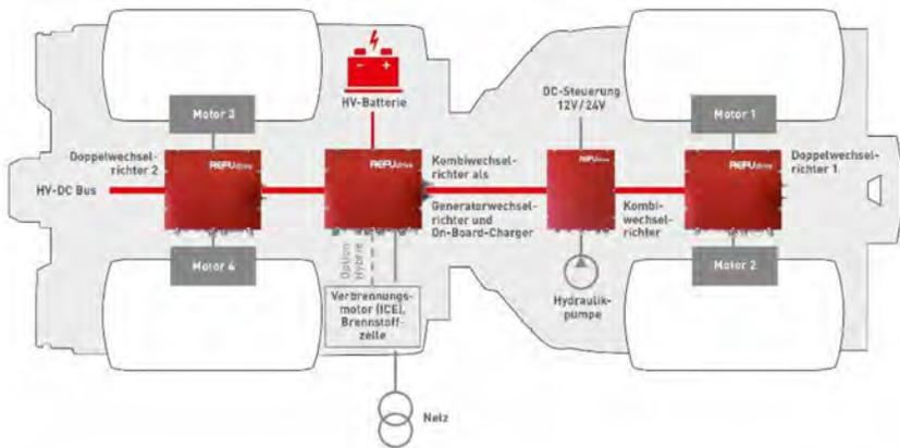
Abbildung 6.1: Antriebsplattform des Muffel+ (Riegert, et al., 2019).
