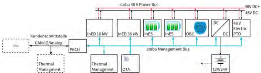
Abbildung 5.1: stoba e-Systems modularer 48-V-Antriebsstrang mit Kundenschnittstelle an der PECU und internem Management Bus und 48-V-Versorgung.
