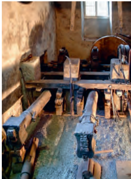
ABB. 91 Wartau, Oberschan. Pradaweg 1. Hammerschmiede. Der Schwanzhammer wurde vom Matzenbach über ein Mühlrad angetrieben. Foto Carolin Krumm, 2012. (KdSA SG).
