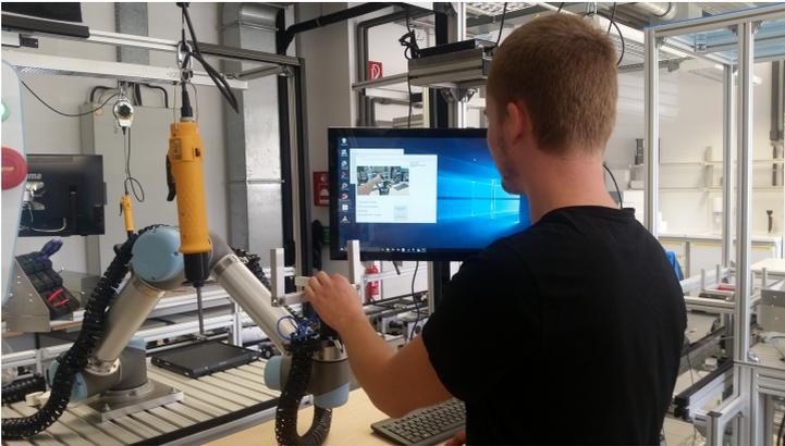
Abbildung 1.4: Beispiel für einen kollaborativen Arbeitsplatz. Quelle: Bremer Institut für Strukturmechanik und Produktionsanlagen (BIME).
