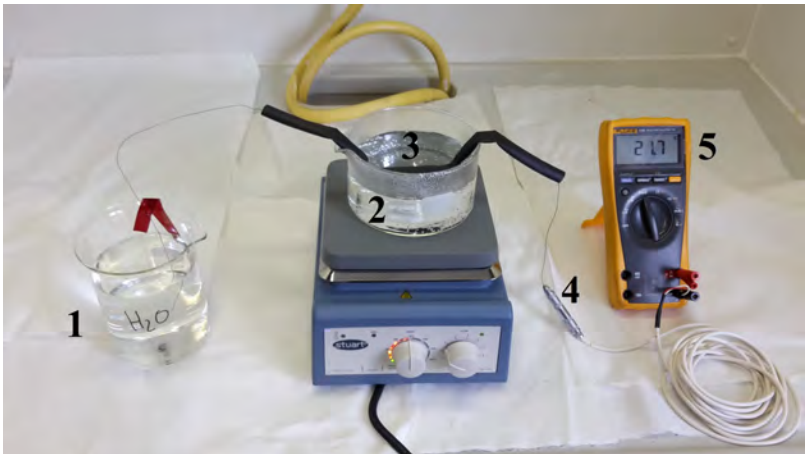
Abbildung 6.11: Versuchsaufbau zur Überprüfung der Steckverbindungen auf Wärmeempfindlichkeit.
