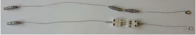
Abbildung 6.10: Verwendete Messketten zur Temperaturmessung des Indenters mit einer LEMO -Steckverbindung (oben) und der OMEGA -Steckverbindung (unten).
