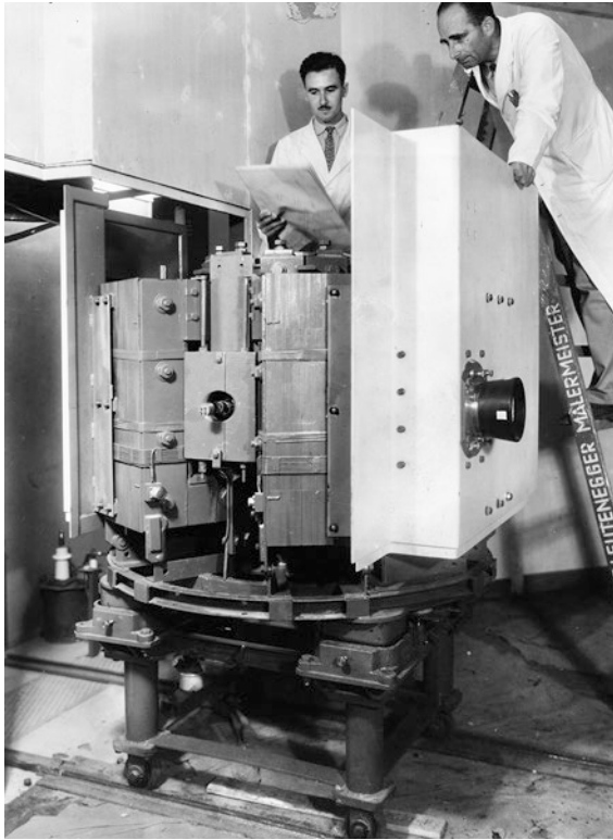
Abb. 2.2 Das erste medizinische Betatron war ein 31-MeV-Betatron für das Krankenhaus in Zürich. Links: D. Camper. (Foto: © ABB Archiv)
