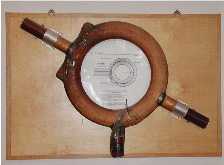
Abb. 2.4 Die Beschleunigerröhre des ersten Betatrons des Osloer Radiumhospitals, die im Eingangsbereich des Krankenhauses ausgestellt ist. (Foto © Knut Bjerkan)
