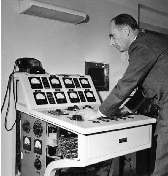
Abb. 2.3 Rolf Widerøe am Bedienfeld des Betatrons, das für das Radiumhospital in Oslo entwickelt wurde – sein zweites 31-MeV-Betatron, das 1952 geliefert wurde. (Foto © NTB scanpix)
