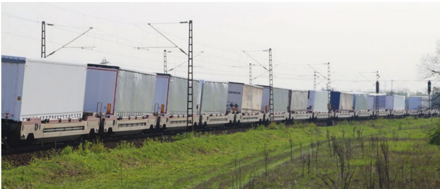
Grafik 2 CargoBeamer-Waggons mit Standard-Planentrailer im Rheintal auf dem Weg nach Italien
