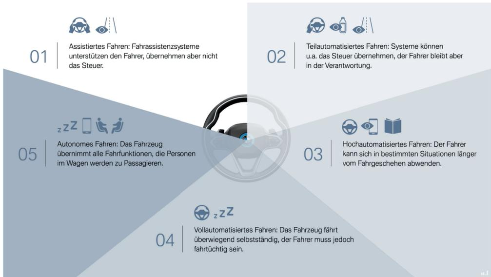
Abbildung 1.2: Fünf Stufen des autonomen Fahrens, Quelle: [15]
