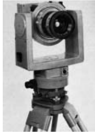
Fig. 46 – Camera metrica terrestre.
