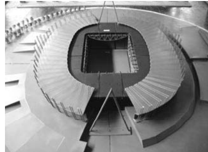
Fig. 42 Foto del modello dello stadio utilizzato nelle prove in galleria del vento
