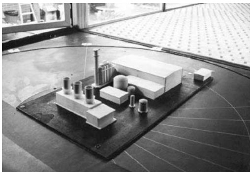
Fig. 49 Foto del modello in scala utilizzato durante le prove in galleria del vento
