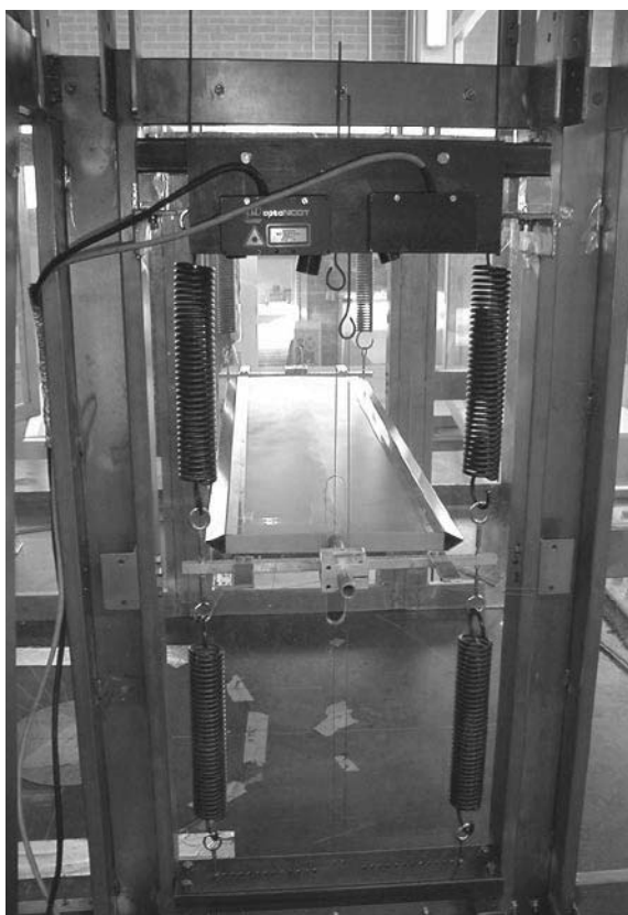
Fig. 40 Foto della cella di carico utilizzata per le prove in galleria del vento
