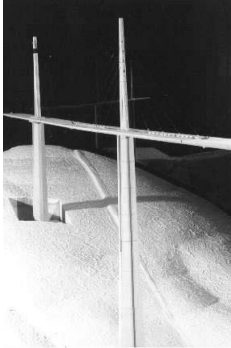
Fig. 65 Modello in scala utilizzato per le prove in galleria del vento
