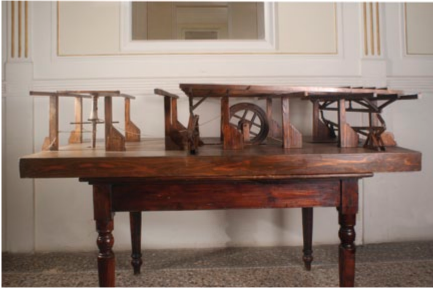
Il modello dell'architetto Ferdinando Ghelli, esibito presso la mostra Scene dell'ingegno allestita al Teatro della Pergola di Firenze, riproduce il meccanismo realizzato da Cesare Canovetti nel 1857 per il sollevamento della platea del Teatro della Pergola.
