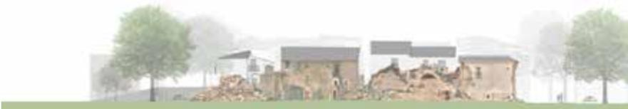
*Fig. 8. Prospetto ovest. Sovrapposizione post sisma/ricostruzione 3d ante sisma*
