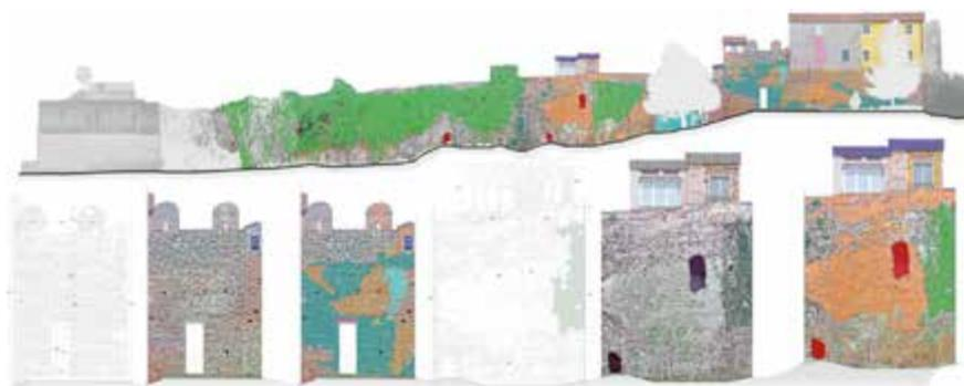
Fig. 12. Foto-raddrizzamento con analisi dell'apparato murario prospiciente il Parco pubblico. È stata effettuata anche l'analisi materica e del degrado per fornire una base da cui partire per il recupero dell'antico manufatto
