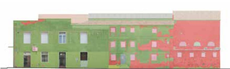
*Fig. 12. Analisi del degrado. Prospetto frontale*
