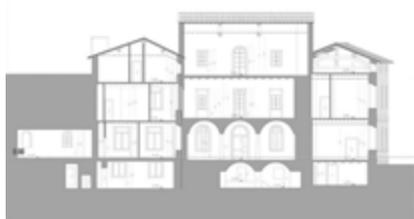
Fig. 6. Sezione del corpo centrale, zona ingresso
