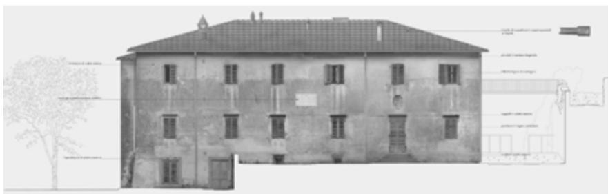
Fig. 10. Fotoraddrizzamento del prospetto Sud della Villa con analisi materica
