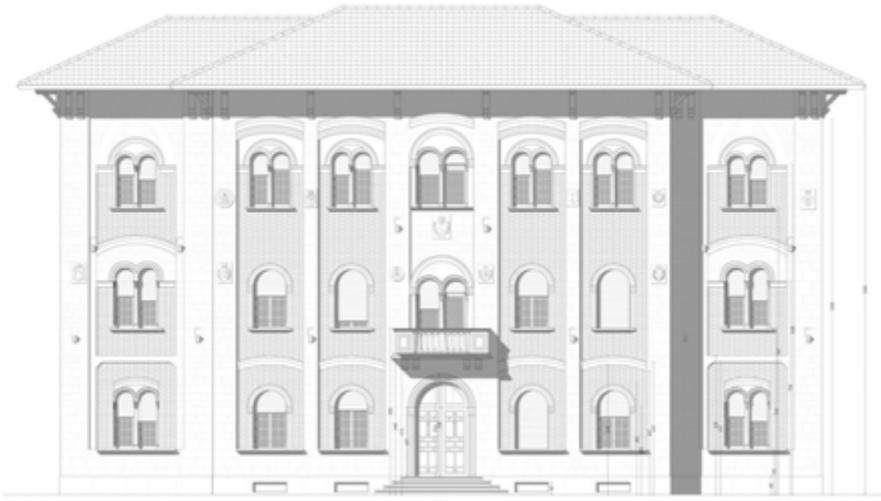
*Fig. 14. Rilievo prospetto principale dell'edificio del Consorzio*
