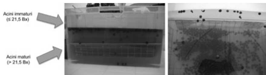
Fig. 3. Separazione densimetrica degli acini
