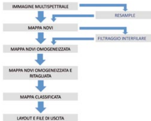
Figura 7. Diagramma di flusso per la realizzazione delle mappe di prescrizione
