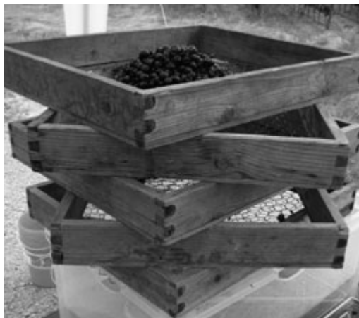
Fig. 4. Disposizione dei setacci per la separazione del MOG dagli acini
