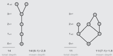
Fig. 4.18 Esempio di *j-graph* a tronco e a cespuglio con relativo calcolo di MD
