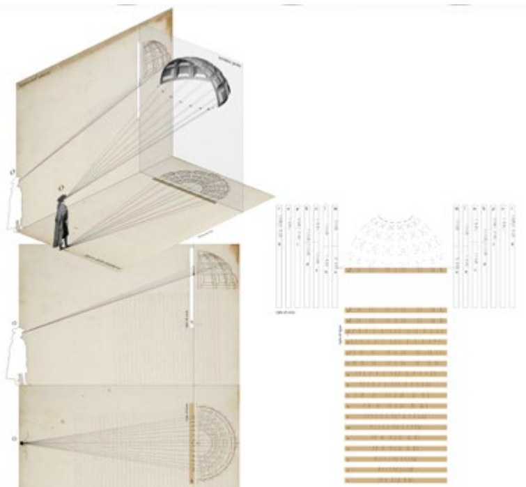
Figura 5. Ricostruzione delle dimensioni del catino absidale e costruzione della prospettiva dei vertici dei lacunari con le righe di legno e le righe di carta sulla base di una distanza principale pari a 10 braccia.
