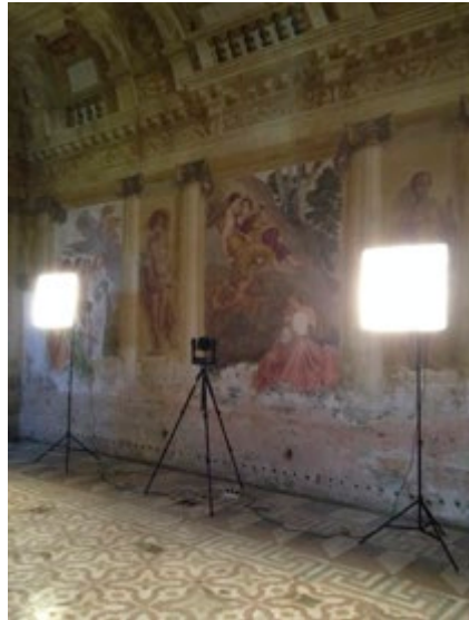
Figura 3 (a destra, b). Fase del rilievo della barchessa est di villa Venier Contarini a Mira, con l'obiettivo 105 mm.
