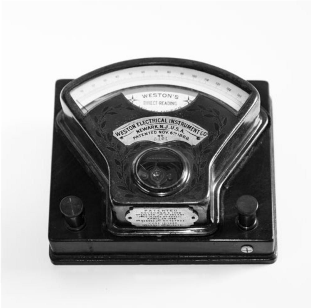
Fig. 5 – Milliampmetro da laboratorio della ditta americana Weston simile a quello illustrato nella fig. 4. [Dipartimento di Fisica e Astronomia, Università di Firenze]
