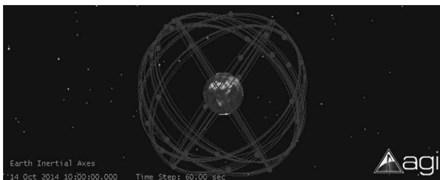
Figura 3.2 – Raffigurazione costellazione satelliti GPS con Systems Tool Kit (STK) – Analytical Graphics Inc. (AGI).
