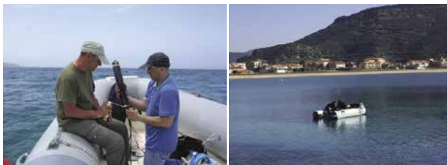
Figura 3 – Installazione del Nortek Current Profiler ed esecuzione dei rilievi batimetrici.
