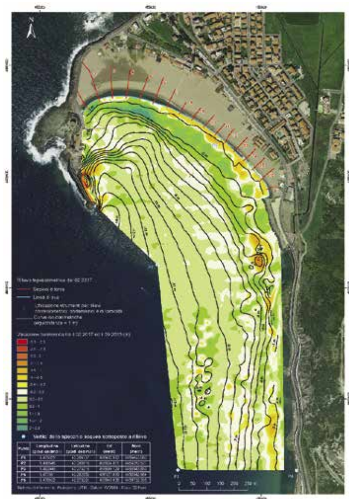
Figura 5 – Tavola delle batimetrie e variazioni tra settembre 2015 e febbraio 2017. Figure 5 – Bathymetric map and changes between September 2015 and February 2017.
