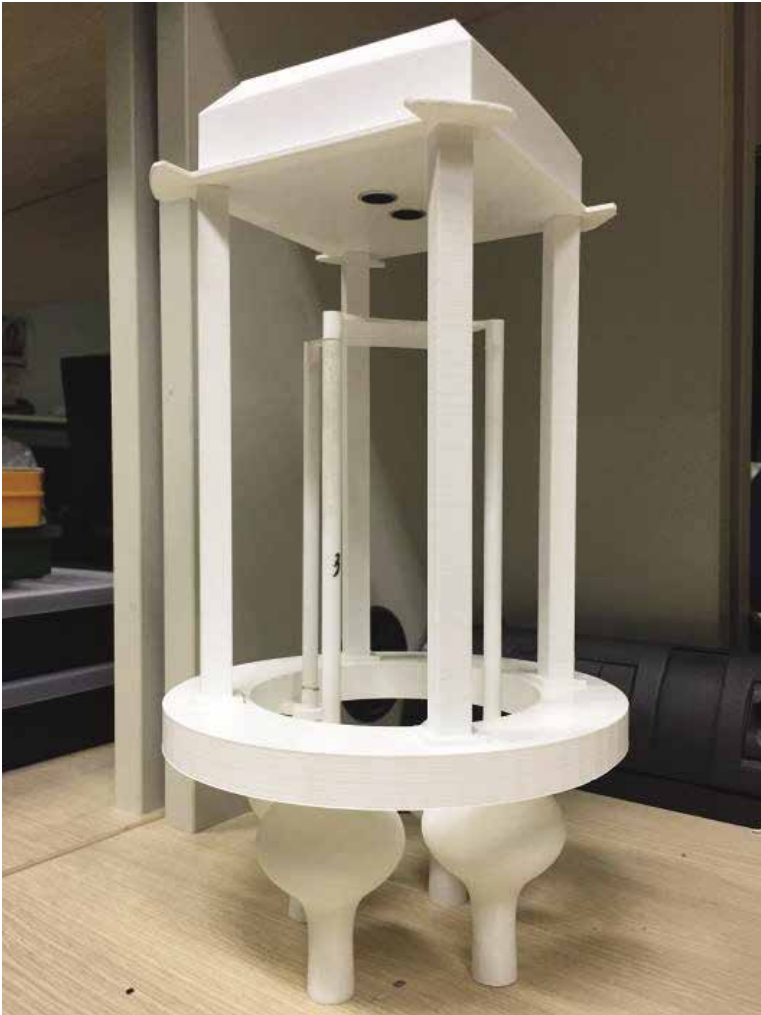
Figura 2 – Prototipo di densimetro per misure di carico in sospensione nei fiumi. Figure 2 – Prototype of a densimeter to measure river suspended load.
