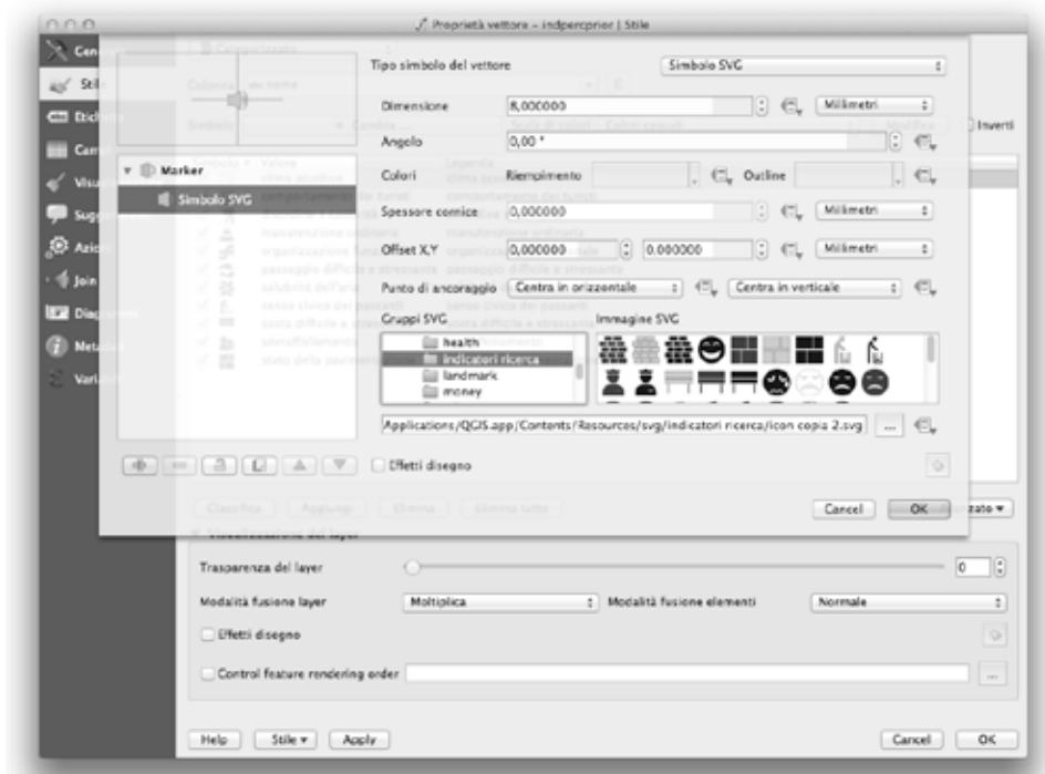
Fig. 167: Esempio di applicazione delle proprietà del vettore con le icone scelte (simboli SVG) in QGIS
