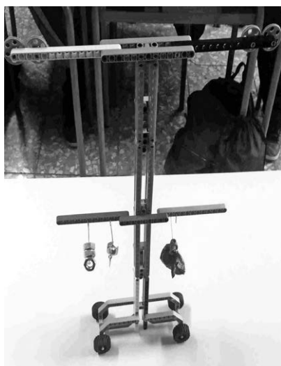
Figura 4 – Leva con tre ganci di cui due alla stessa distanza dal fulcro ed uno a distanza doppia.
