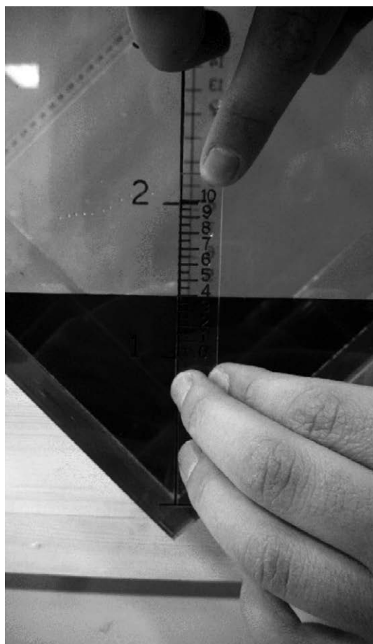
Figura 8 – La lettura nella posizione ruotata viene perfezionata con l’uso di un righellino che suddivide l’unità in decimi: si legge in questo caso il valore 1,4.
