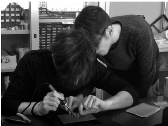
Figura 6 – La saldatura dei collegamenti elettrici.
