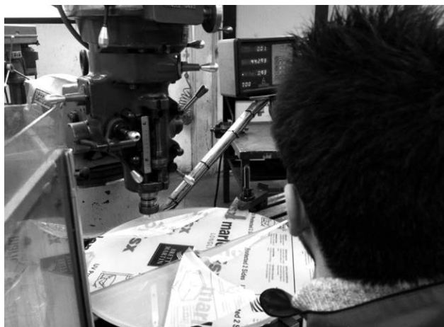
Figura 4 – Uno studente alla fresatrice taglia il plexiglass per realizzare alcune delle parti del calcolatore.
