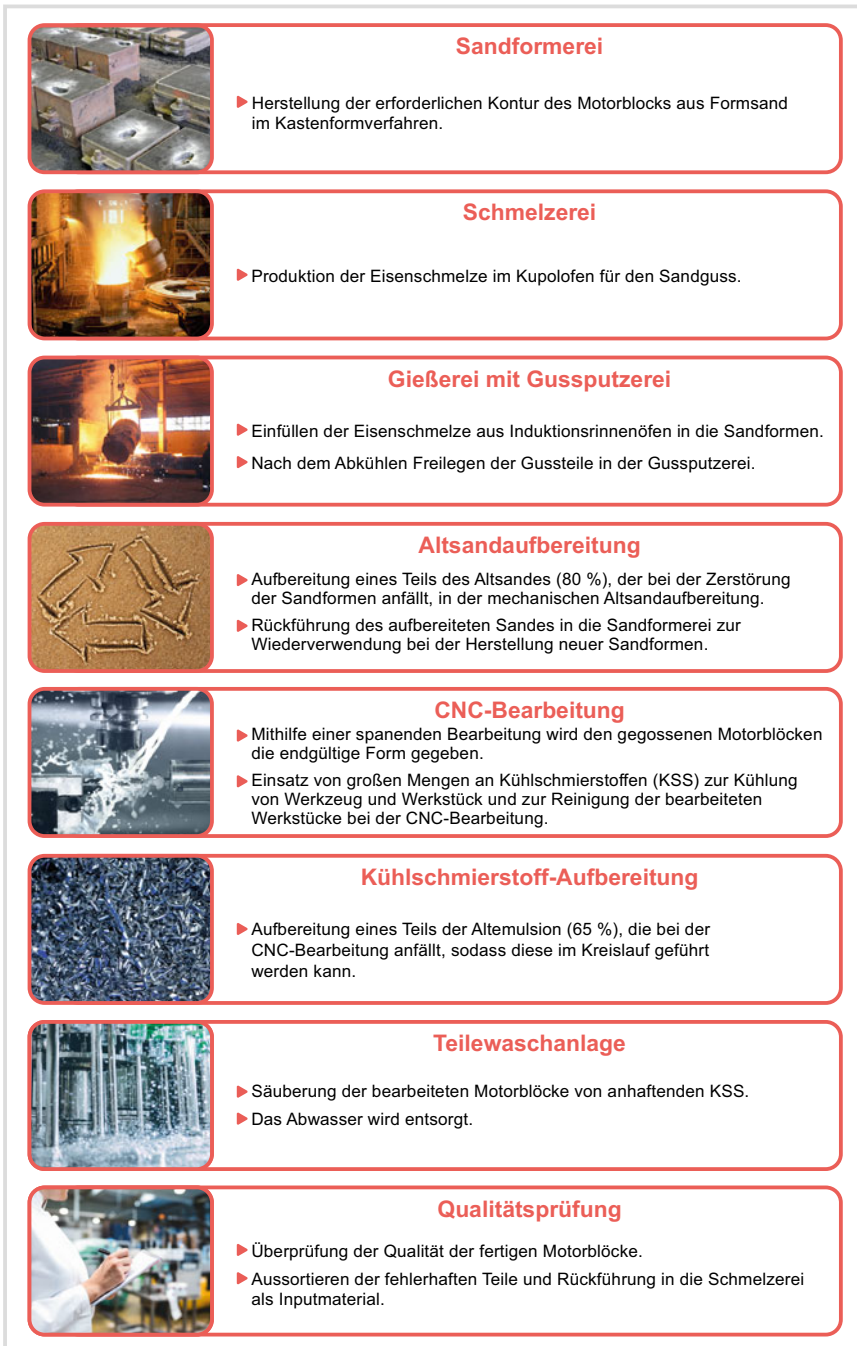
Abb. 4.7 Prozesse zur Herstellung eines Motorblocks im Planspiel RE:MATERIAL
