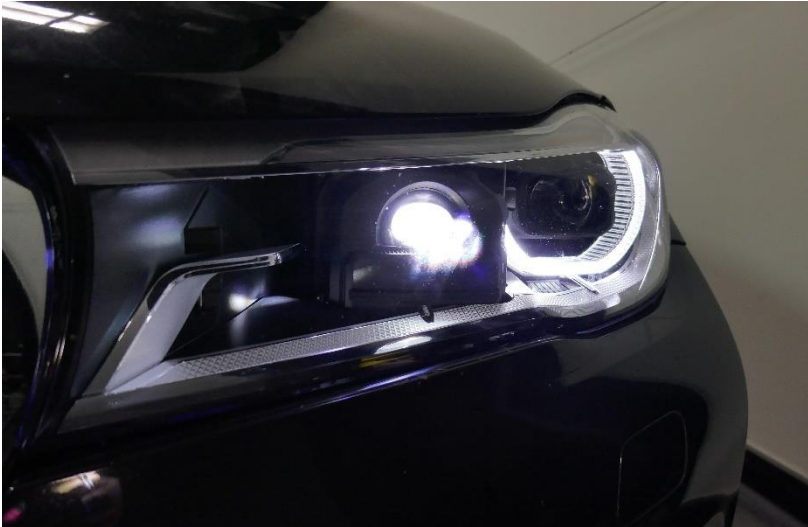
Abbildung 3.51 Linker DMD-LED-Hybrid-Scheinwerfer eingebaut in einen G12 mit eingeschaltetem DMD-Modul.
