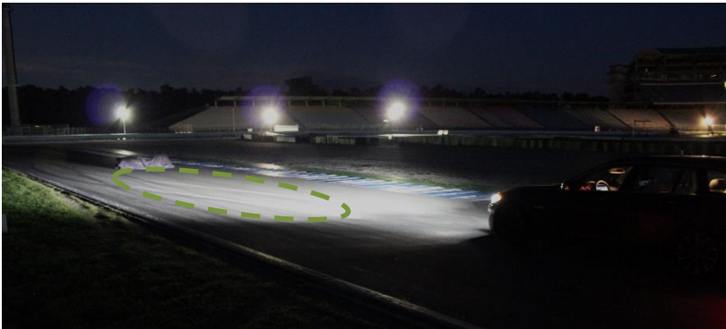
Abbildung 4.1 Seitliche Betrachtung der Projektionen im Ausweich-Fall aus der Studie 2. Die Linien sind im markierten Bereich projiziert und sind aus einer anderen Position, als der des Fahrers, mit bloßem Auge kaum erkennbar.
