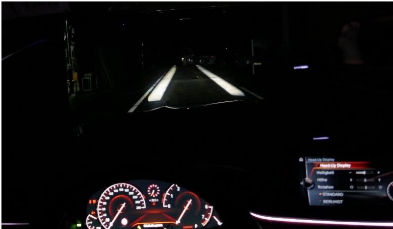
Abbildung 3.53 Photographie aus Fahrersicht der über das DMD-Zusatzmodul dargestellten Fahrzeugbreitendarstellungen. Für eine bessere Visualisierung der Funktion wurde die fotografische Darstellung ohne Basis-Abblendlicht gewählt.
