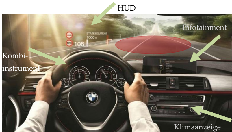
Abbildung 2.6 Diverse Anzeigen im Innenraum. Viele Systeme vermitteln dem Fahrer während der Fahrt Informationen. Alle gemeinsam lenken sie den Blick des Fahrers weg vom relevanten Bereich: der Straße vor ihm (rotes Oval).
