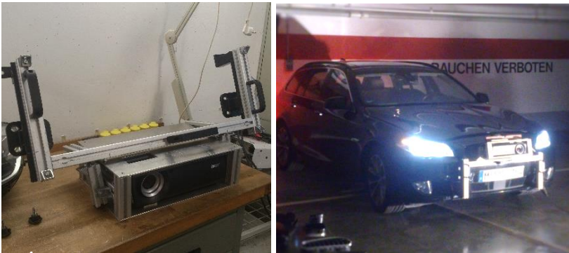
Abbildung 3.24 Acer Projektor in einem angepassten Rack zur Montage im Testfahrzeug (A, hier kopfüber gelagert) und Versuchsfahrzeug mit im Rack eingebundenem Projektor (B).
