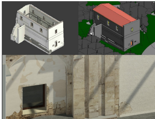
Fig. 07. Modellazione parametrica dello stato di fatto della chiesa, a sinistra, e modelli nurbis dell'apparato decorativo barocco (elaborazione grafica degli autori).
