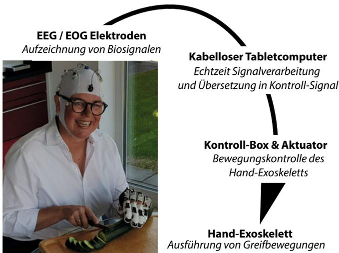
**Abb. 1** Neurale Steuerung eines individualisierten Hand-Exoskeletts mittels Elektroenzephalographie (EEG) und Elektrookulographie (EOG). Die Signale werden an einen tragbaren und kabellosen Tablett-Computer gesendet, dort in entsprechende Steuerbefehle übersetzt und an das Hand-Exoskelett übertragen
