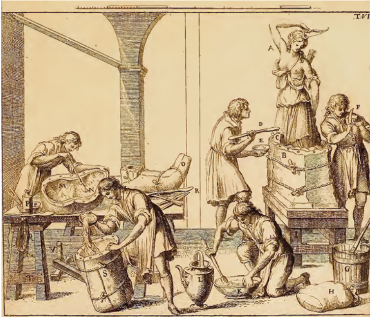
FIGURE 8.6 Francesco Carradori, Plate v, 'Nella quale vien dimostrato il metodo da tenersi per far le Forme di Gesso', from Istruzione elementare per gli Studiosi della Scultura (Firenze 1802) PHOTO: GETTY RESEARCH INSTITUTE
