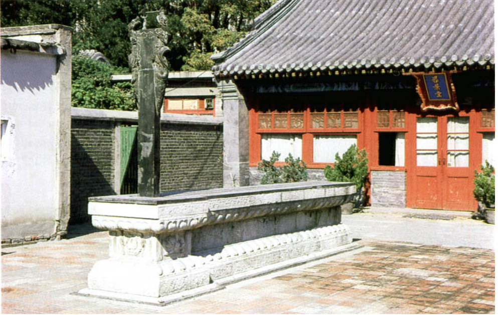
120 - Gnomon de Pékin - La barrette tenue par le montant noir se projette à midi sur une règle graduée horizontale
