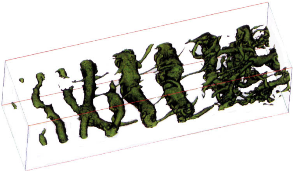
Figure III-7 : isosurface de basse pression dans une couche de mélange se développant spatialement, forcée par une perturbation tridimensionnelle.
