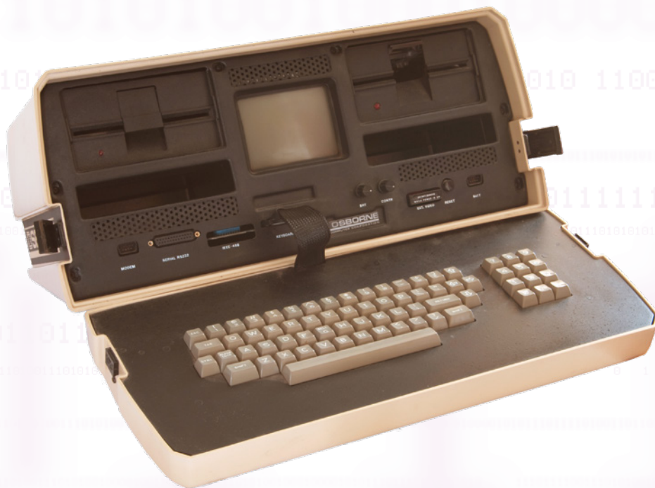
Ordinateur « portable » Osborne 1. On voit les deux lecteurs de disquette et l'écran, accompagnés de divers connecteurs.
