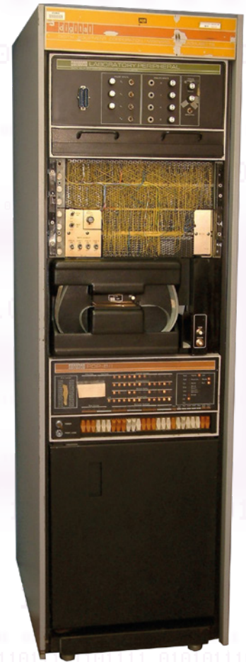
Mini-ordinateur PDP-8i. De haut en bas : appareil de laboratoire, disque dur (32 kmots de 12 bits), lecteur de bande papier, processeur.
