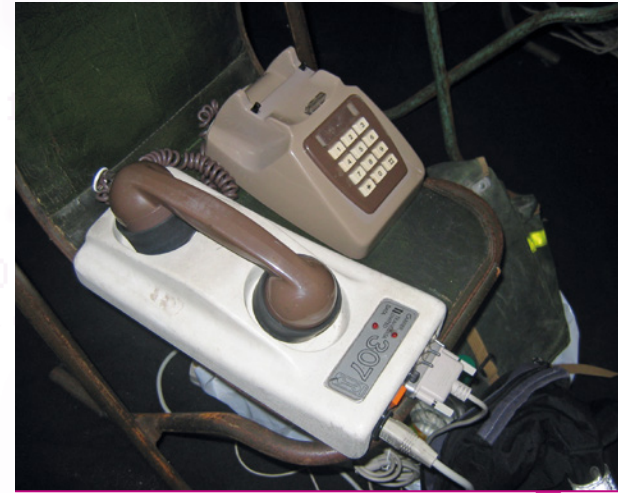
Modem acoustique (boîte blanche) « dialoguant » avec le combiné téléphonique via un haut-parleur et un micro, et relié à l'ordinateur via le câble en bas à droite.
