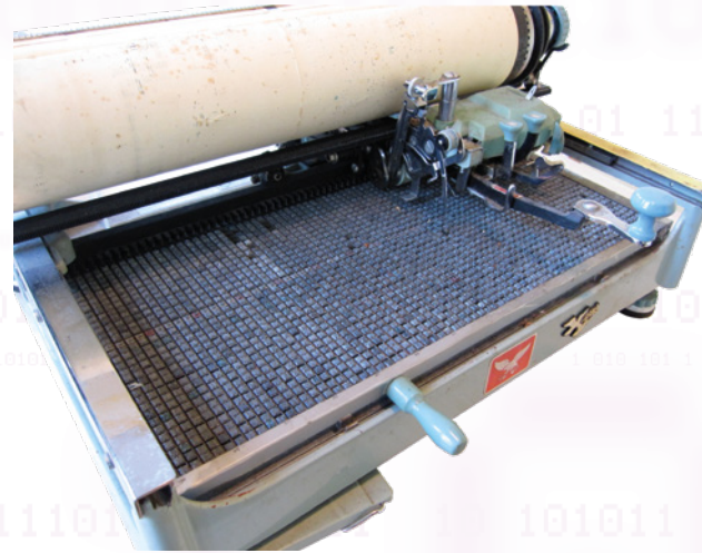
Machine chinoise de 1971 avec sa table contenant environ 2 500 caractères. Les manettes permettent d'en choisir un (en couissant la table) et de l'imprimer.
