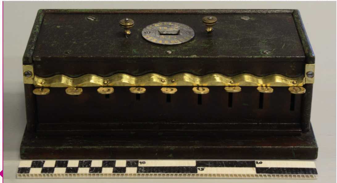
Additionneur à touches (1844) de J.-B. Schwilgué.
