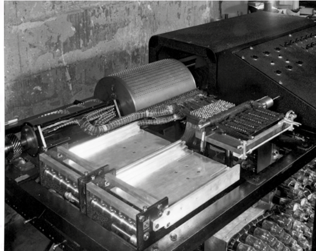
▶ Calculateur ABC. En bas à droite, les tubes électroniques servant aux calculs ; le tambour du fond porte les condensateurs mémorisant les bits de données.
