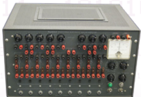
Heathkit EC-1, ordinateur analogique conçu pour l'enseignement.
