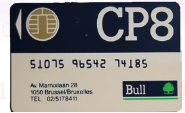
Carte à microprocesseur Bull de Michel Ugon, développée en 1977. Elle combine trois technologies : puce, caractères OCR, et piste magnétique au verso.
