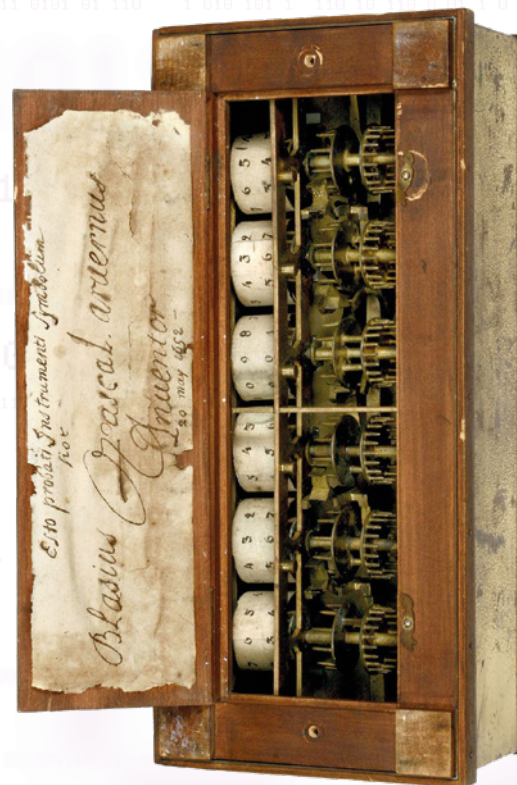
Intérieur de la machine arithmétique de Pascal (réplique vers 1970).
