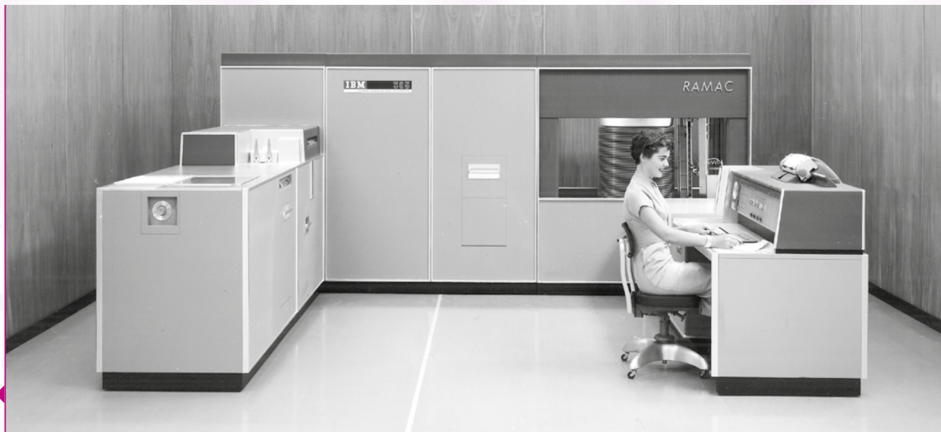
IBM 305 avec disque dur, visible dans le panneau transparent derrière l'opératrice.
