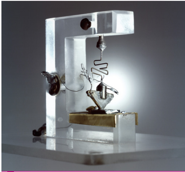
Le premier transistor, devenu objet d'exposition aux laboratoires Bell.
