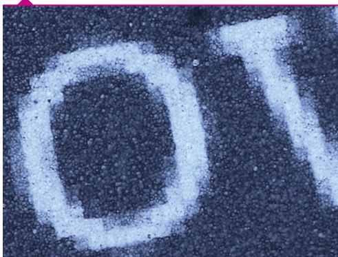
Affichage d'une liseuse montrant les microcapsules.
