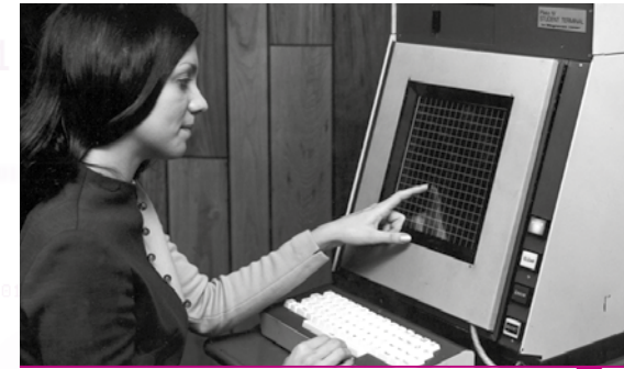
Écran tactile utilisé sur le système d'enseignement assisté par ordinateur PLATO IV vers 1973.
