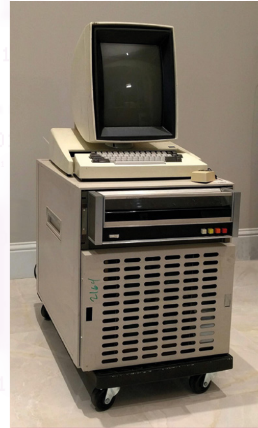
Le Xerox Alto. De haut en bas : l'écran au format portrait, le clavier et la souris, le lecteur de disques magnétiques amovibles et l'unité centrale.
