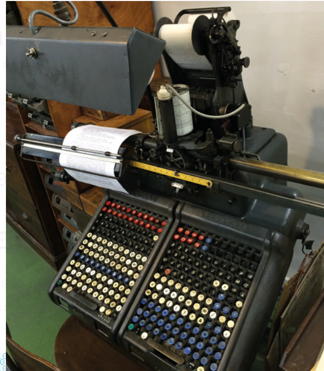
Monotype : clavier et système de codage sur bande perforée (1887).
