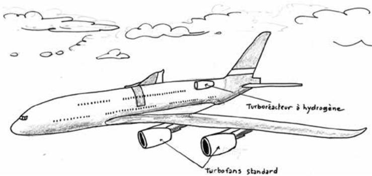
**Figure 6.6** | Test en vol du A380 avec, sur le fuselage arrière, la nacelle contenant le turboréacteur à hydrogène.
