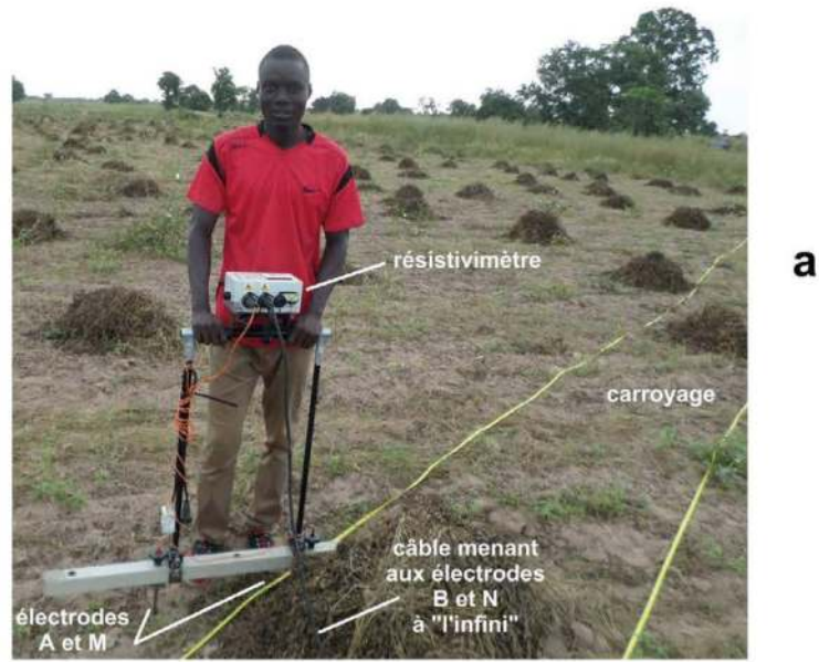
Cas 1 : Sol composé d'un matériau homogène
