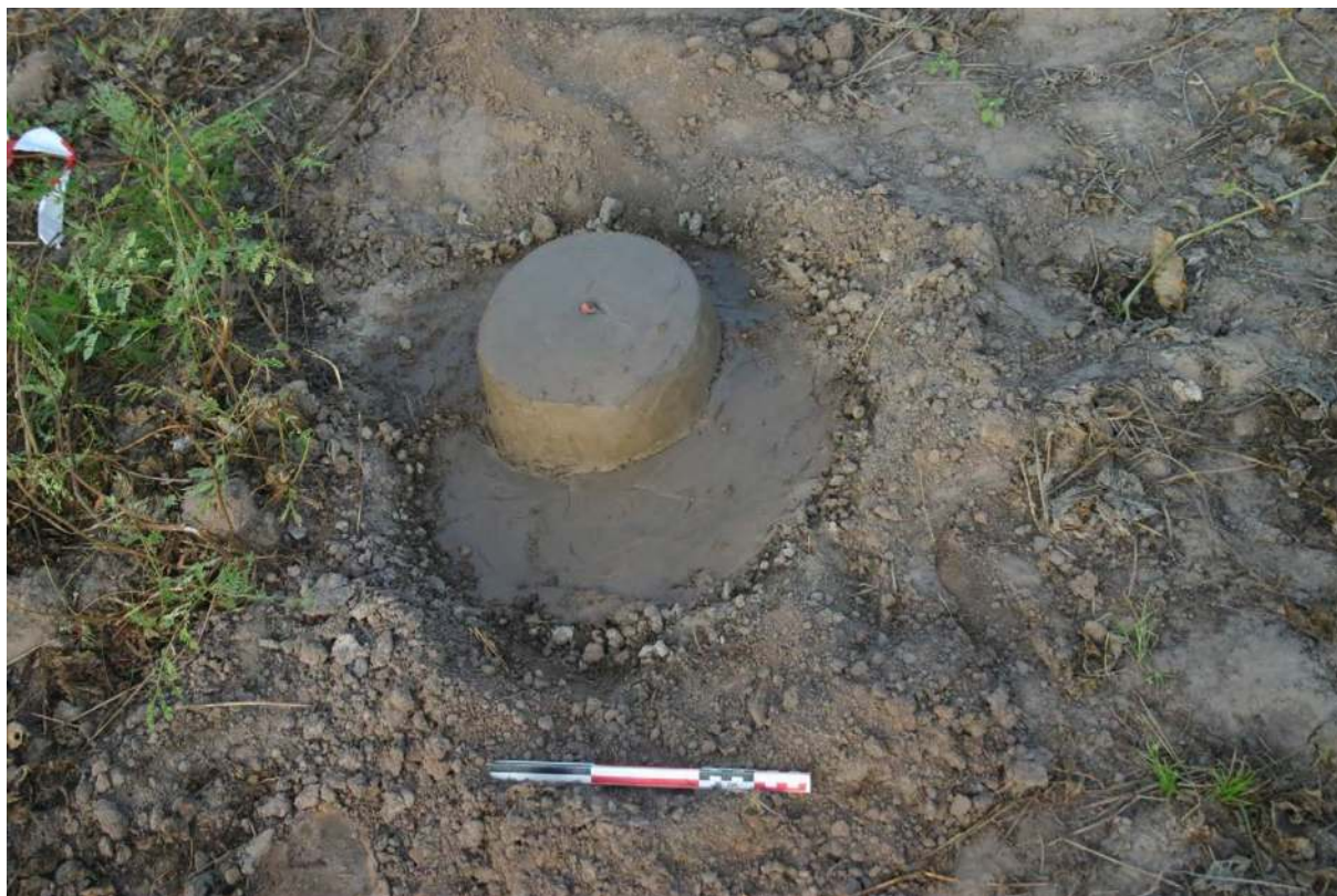
1.3.1 - Fig. 4 : Relevés topographiques : l'une des bornes topographiques implantées selon un maillage de 40 m de côté. Cliché L. Laporte.
